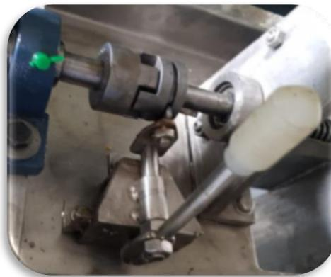
**Figura 45.** Conjunto de accionamiento para manual o automático
