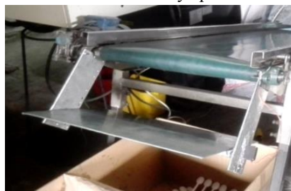
Posición de descarte de producto (ManuelSalazar & CristianVeloz)
