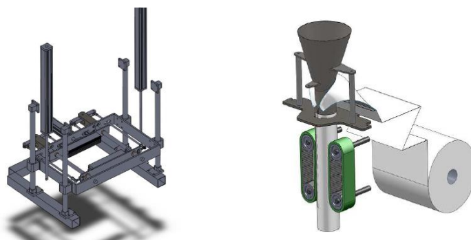
(a) Sistema de arrastre por mordazas (ManuelSalazar & CristianVeloz) (b) Sistema de arrastre por correas (Moreno Zapata, 2010)
