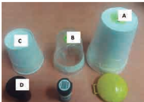
Figura 4. Cámaras de difusión de prueba y monitores comerciales de referencia
