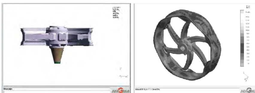
Rys. 1. Deformacje felgi po procesie odlewania [1]
