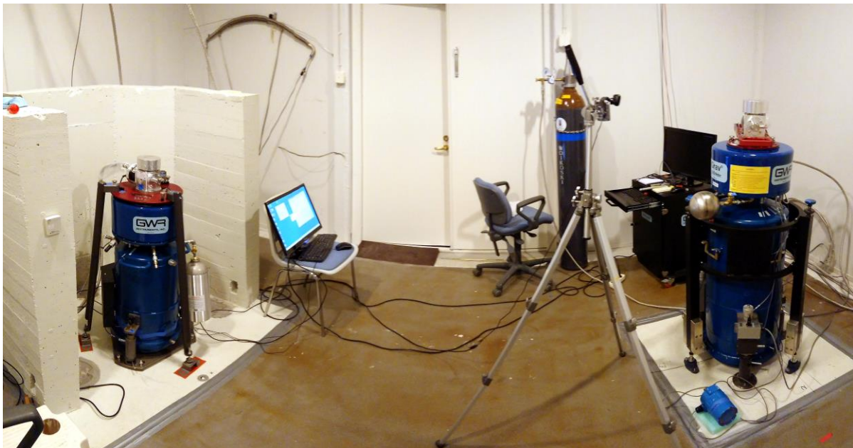
Kuva 1: Suprajohtavat gravimetrit painovoimalaboratoriossa Metsähovissa marraskuussa 2017. Vasemmalla on iGrav-013, joka on vanhalla T020:n pilarilla. Oikealla on iOSG-022. Laitteiden sensorit ovat 3 metrin etäisyydellä ja noin 10 cm korkeudella pilarista.
