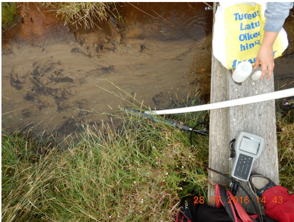
Kuva 7. Näytteenottoa Löyttynojasta.. Kuvassa näkyvät käytetyt HDPE pullot, valkoisessa putkessa on sedimentinlämpötilamittari Therma Plus, kuvassa näkyy myös YSI600, jolla mitattiin veden lämpötilaa, pH:ta sekä sähkönjohtavuutta. Kuva Anne Rautio 28.7.2016.
