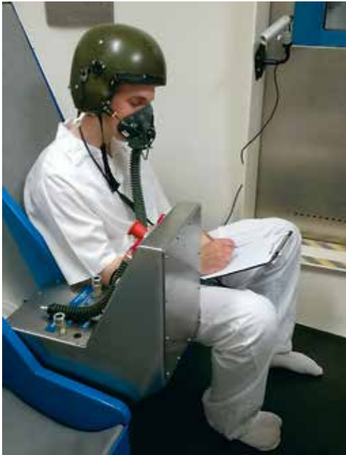
KUVA 1. Sotilaslentäjien hapenpuutekoulutus alipainekammiossa. Fyysisten oireiden lisäksi lentäjille pyritään havainnollistamaan henkisen suorituskyvyn heikkenemistä. Kuva: Jarmo Skyttä.
