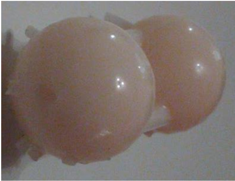
Kuva 15. Tavoitellut 2,6 mm reiät eivät pysyneet aukinaisina tulostusprosessissa vaan täyttyivät polymeeristä. Liian useat pienet tukirakenteet haittasivat kappaleen viimeistelyä.
