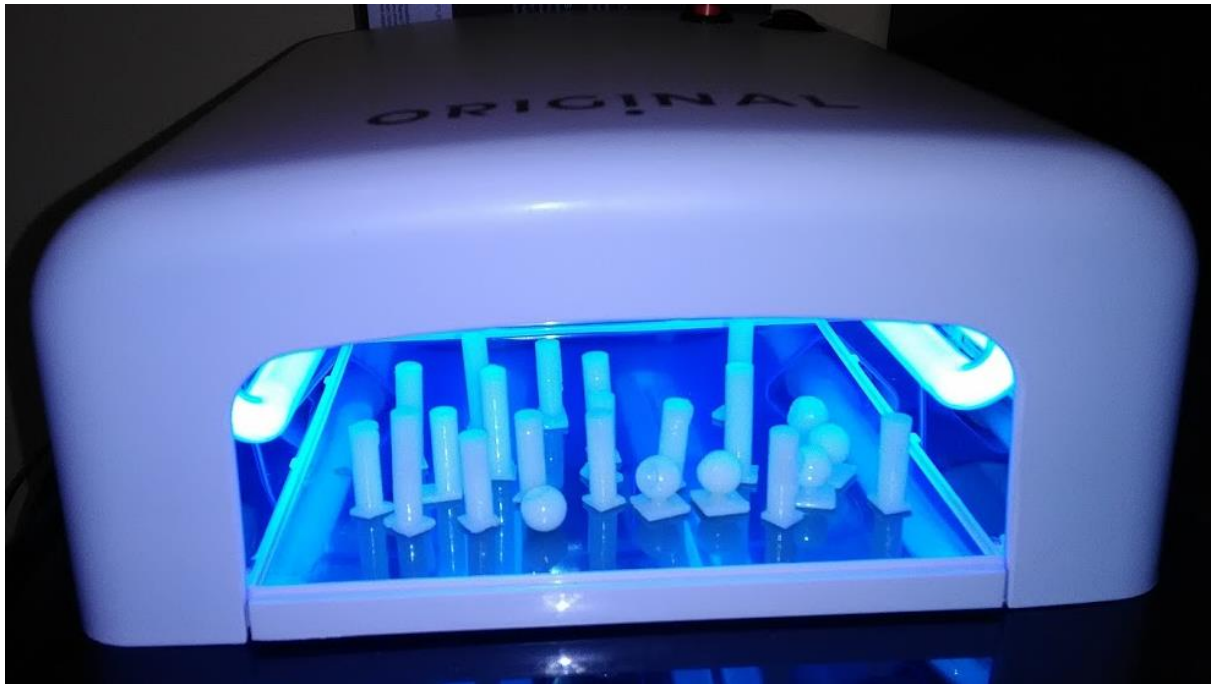
Kuva 18. UV-uunissa tehtiin polymeroinnin viimeistely
