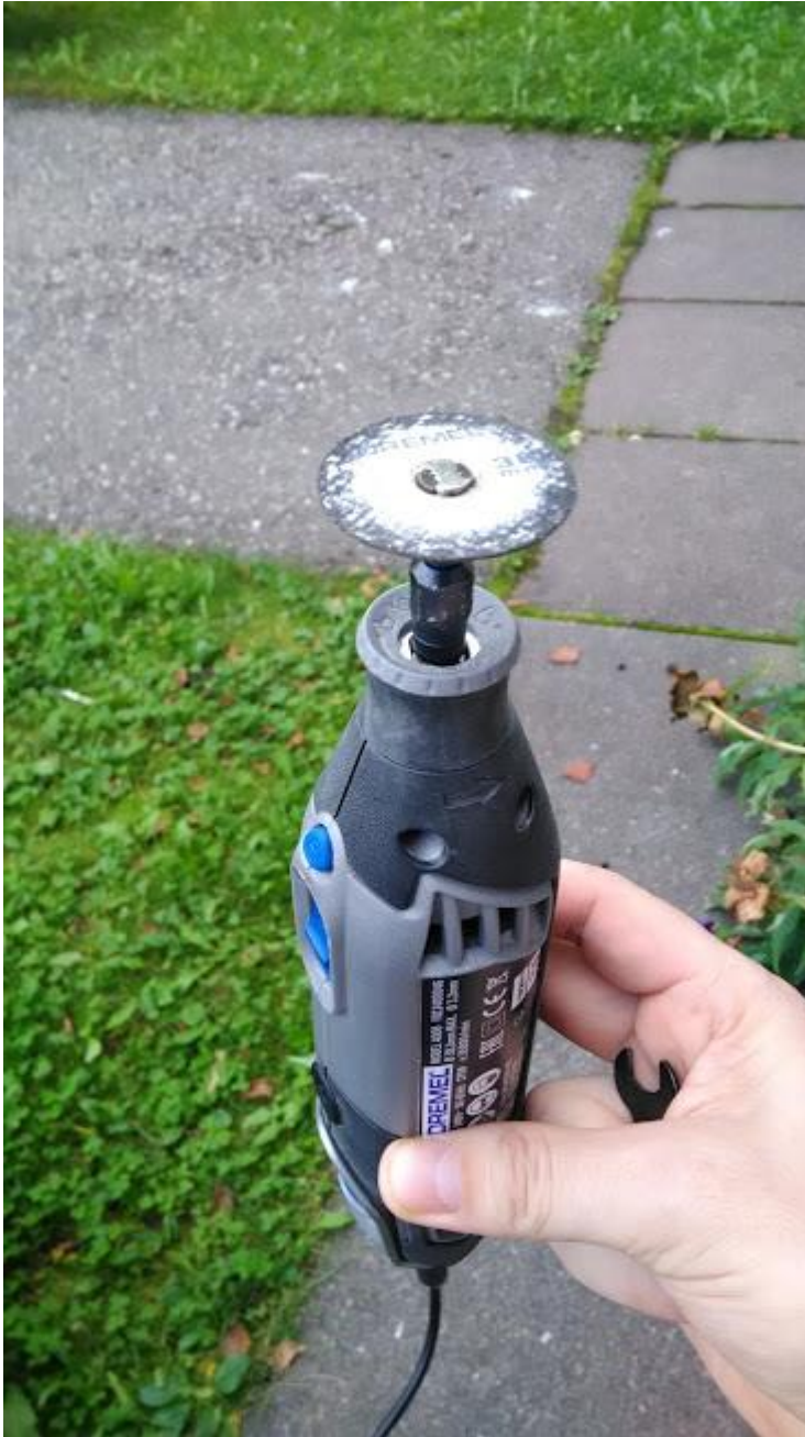
Kuva 21. Molekyylisidoksia mallintavien putkien irrottamiseen tukirakenteista käytettiin Dremelin katkaisulaikkaa kierrosnopeudella 30 000 r/min.
