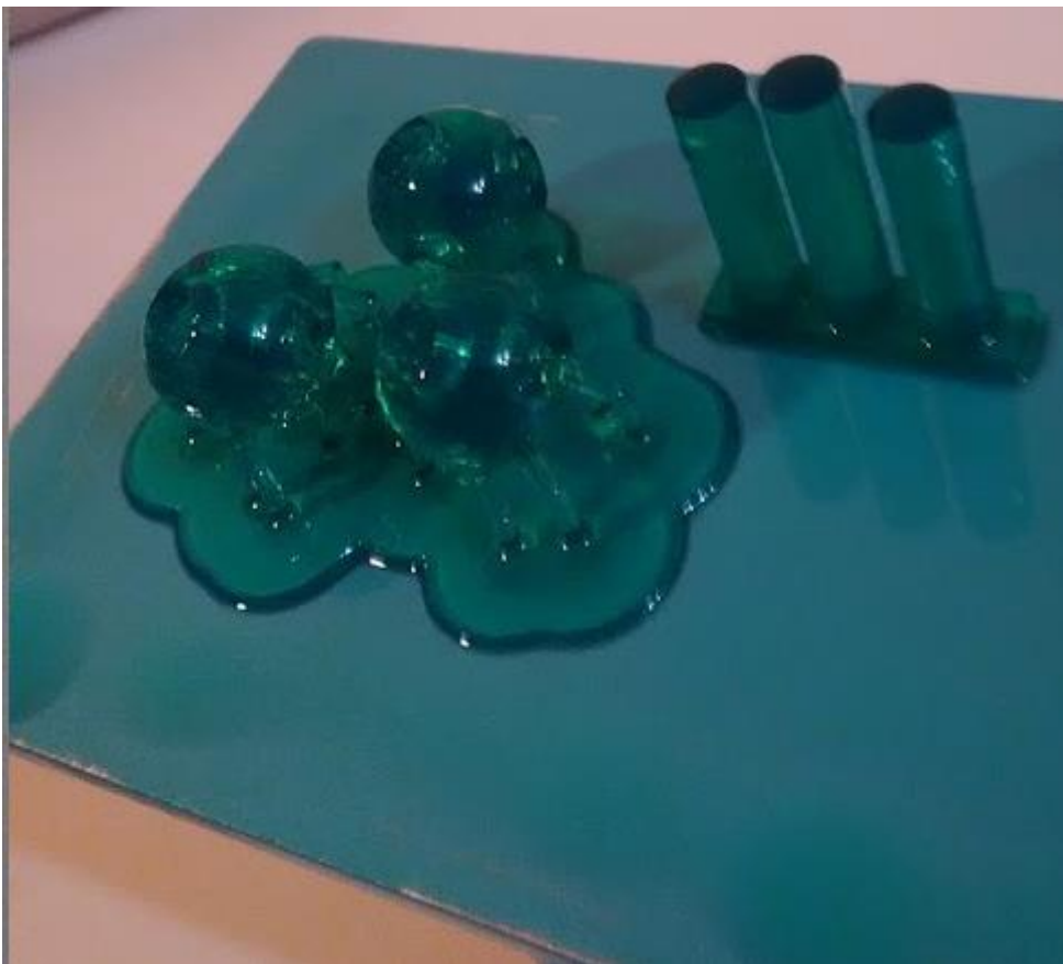
Kuva 16. Kolmen molekyyliidoksen ja kolmen hiiliatomin onnistunut tulostus. Kappaleet pysyvät kiinni tukirakenteissa ja ovat muodoltaan tavoiteltuja. Tukipohja ei kuitenkaan irronnut tulostusalustasta helposti, koska pohjakerroksen polymeeroitumisaika oli säädetty liian pitkäksi.
