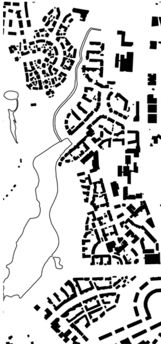
Kuva 221. Rakeisuuskartasta voi havaita, että Pikku Huopalahden asemakaava koostuu useammasta erilaisesta osasta. Puutarhakaupungit, Välimeren satamakaupungit, keskiaikaiset kaupungit lukuisine aukioineen ja perinteinen bulevardirakentaminen ovat vaikuttaneet suunnitteluidean taustalla. (Maanmittauslaitoksen Maastotietokannan rakennukset 09/2014).
