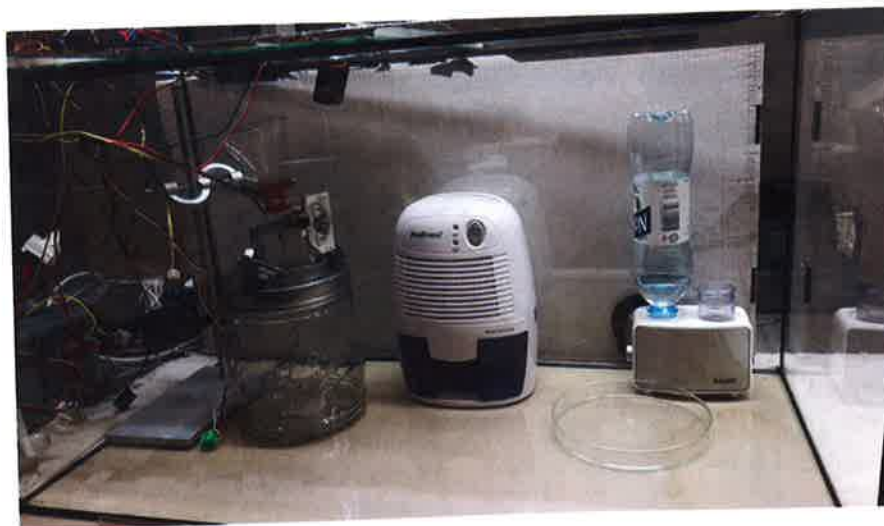
Kuva 3. Tutkittava aine sijoitettiin kammion pohjalle lasivatiin. Kammioilmaa kostutettiin ultraäänihöyrystimellä. Kammion ilman kosteus tiivistettiin Peltier-kuivaimella vedeksi. Kammiossa mitattiin jatkuvatoimisesti lämpötilaa, kosteutta, TVOC-pitoisuutta ja tiivisteveden pintajännitystä.
