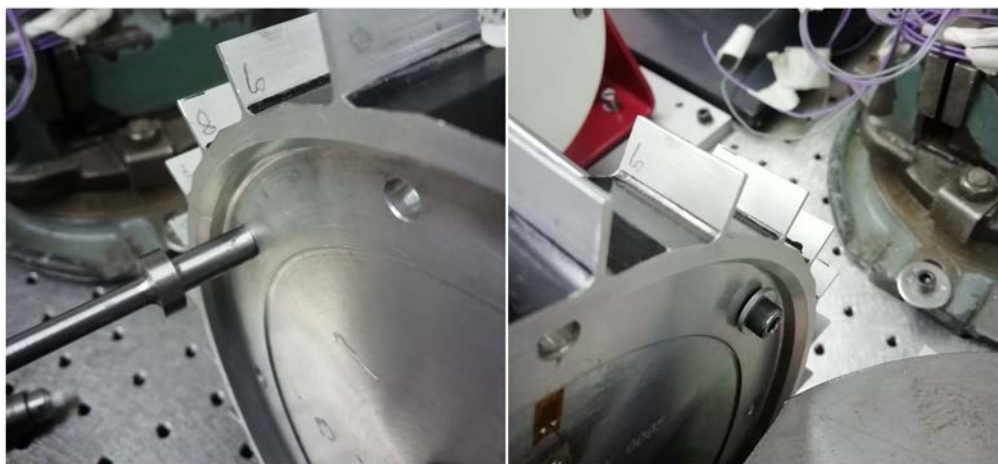
Figura 6.2: Configurazione operativa di ancoraggio tra shaker e blisk
