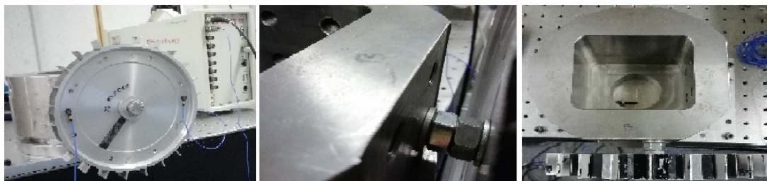
Figura 4.1: Configurazione sperimentale: blisk vincolato
