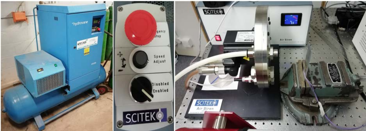
Figura B.8: Strumentazione utilizzata per l'eccitazione mediante getto d'aria
