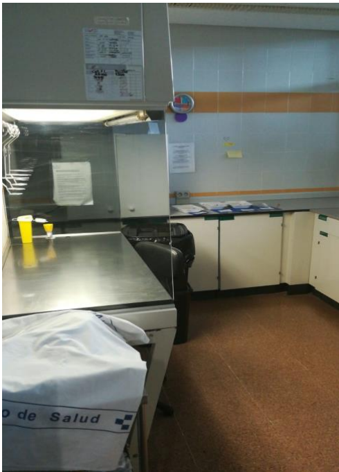
Figura 3: Primera Sala, campana de flujo laminar horizontal.
