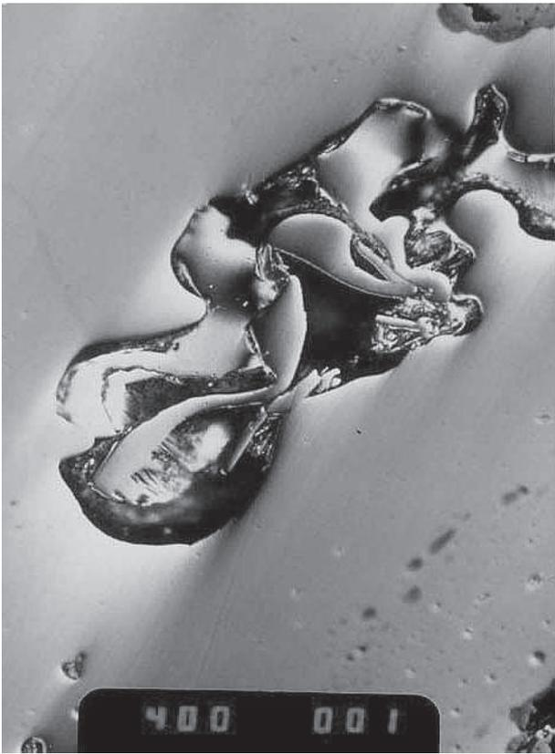
**Fig. 13.** Micrographie de scorie d'épuration : replis en cours d'écrasement, un des témoins de l'épuration (Blessey-Salmaise, Forge F104), éch. 15 (cl. Ph. Fluzin) (extrait de MANGIN et alii, 2000a, pl. XXX, 6, p. 228).
