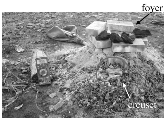
Figure 4 : Conditions expérimentales. Il s'agit du moment où le creuset est mis à préchauffer. Figure 4: Experimental condition. It's the moment when the crucible is put to heat.
