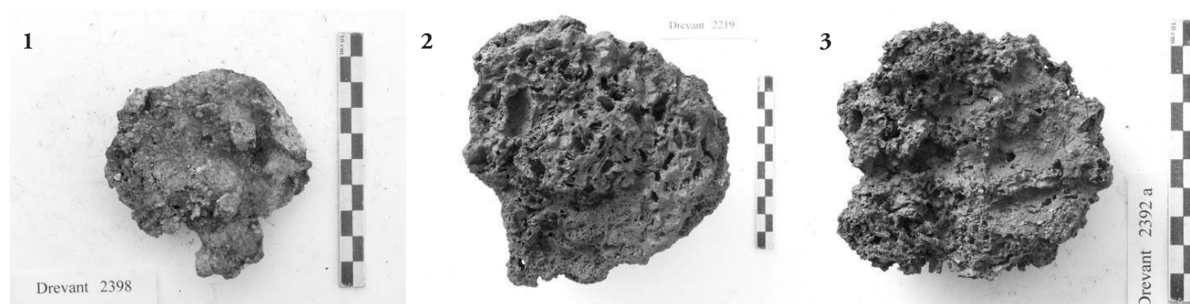
Figure 1 : Exemples d'aspect morphologique de scories argilo-sableuses SAS (1), de scories grises denses SGD + SAS (2) et de scories ferreuses rouillées SFR (3).
