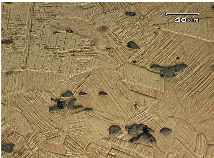
Fig. 6. Photographie en microscopie optique de l'échantillon 2. Les sulfures sont moins allongés (20 \mu\text{m} ) que dans l'échantillon 1 alors qu'ils proviennent du même objet mais à deux endroits différents.
