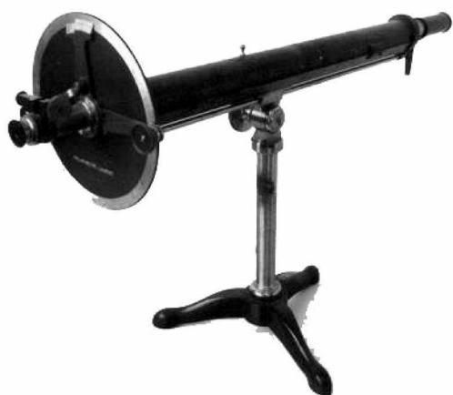
fig. 2 - Polarimètre Laurent et sa reproduction, dans D. Sidersky. Polarisation et saccharimétrie , Paris, Gauthier-Villars, 1900, p.61 (coll. part.).
