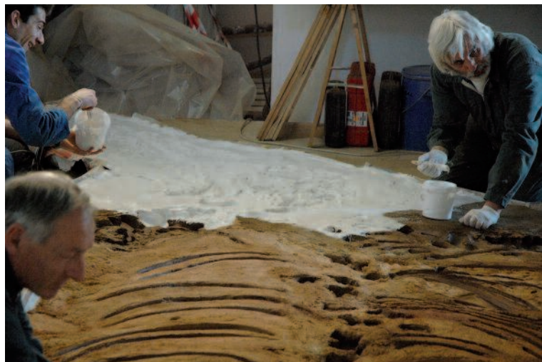
Application de la première couche de gelcoat © T. Contucci
