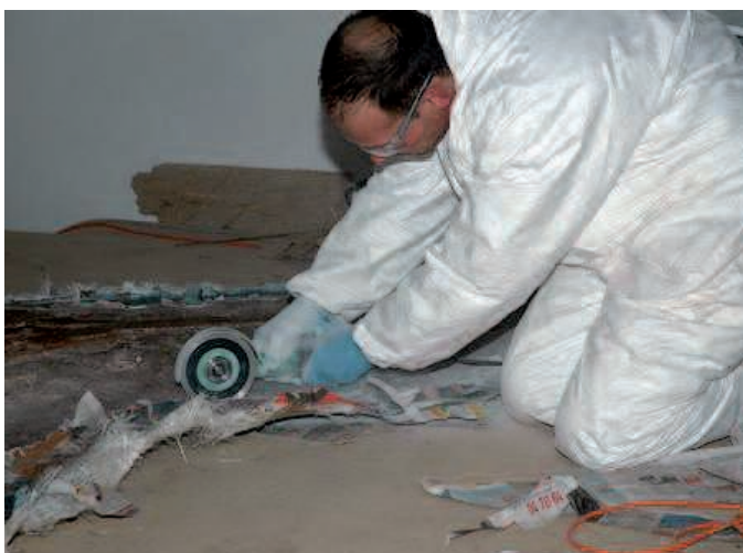
Découpe à la disqueuse de la bordure du positif recouverte de papier journal durci car imbibé de polyester catalysé © R. Roch
