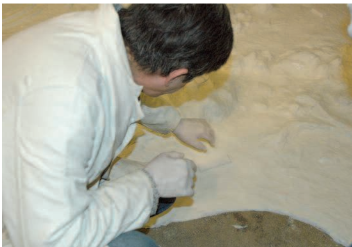
Collage au silicone des plots de positionnement qui permettront le repérage exact de la membrane dans la coquille. © T. Contucci
