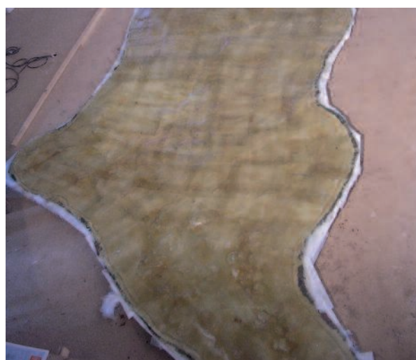
Réalisation de la coquille en voile et mat de verre et polyester étalé au rouleau © R. Roch
