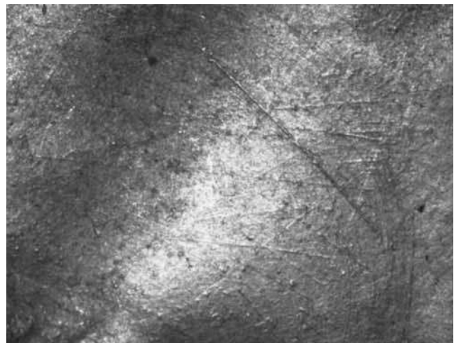
Figure 6: Image under the microscope showing the surface of the appliqué which presented traces of casting (photograph by P. Penkova). Figure 6 : Images sous loupe binoculaire illustrant la surface des appliques présentant des traces de coulé (photographies par P. Penkova).
