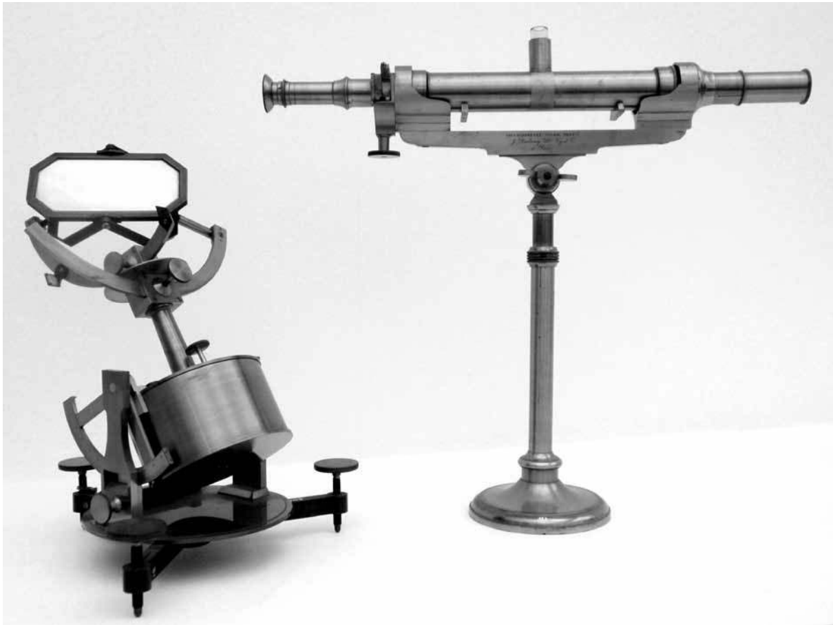
fig. 2 - Un héliostat de Silbermann et un saccharimètre de Soleil signés Duboscq. Ces deux instruments sont pratiquement identiques à ceux qui, avec d'autres, permettent au célèbre constructeur parisien d'obtenir la plus haute récompense de l'exposition ainsi que l'admiration unanime des commentateurs. (Collection de la Fondazione Scienza e Tecnica, Florence)
