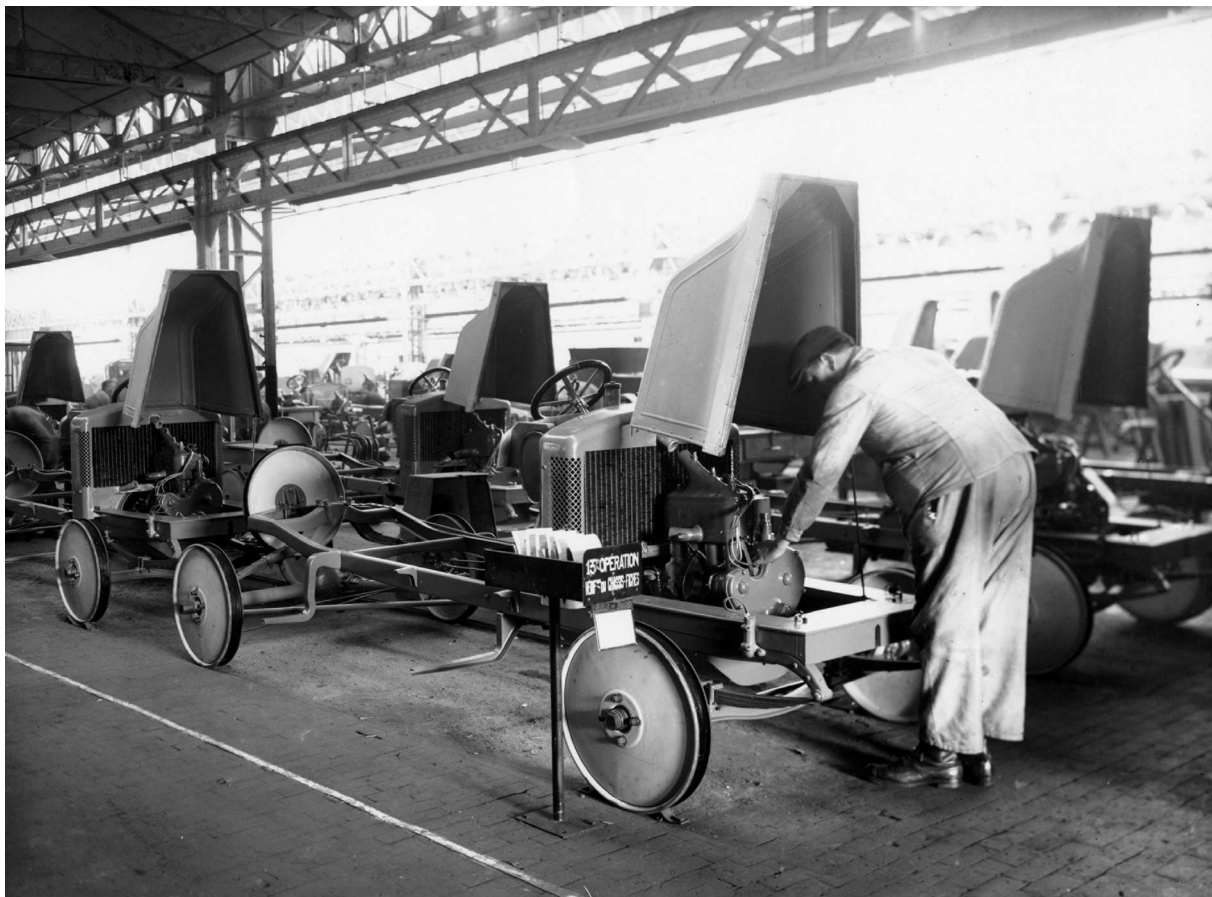
fig. 6 - Photographie et dessin de la sortie de chaîne de C5 (1922). On constate que la "13 e opération" de la photographie a été transformée en une "12 e opération" sur le dessin - Source : photos Renault Communication / droits réservés.
