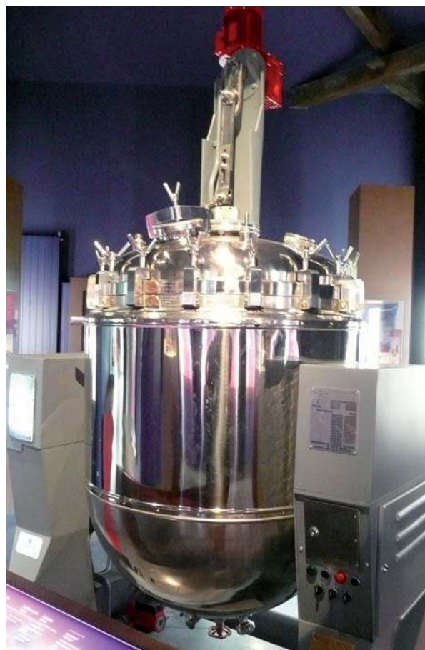
Un exemple du patrimoine du XX e siècle : un fermenteur de type Frenkel au musée de Sciences biologiques Charles Mérieux © W. Atkinson
