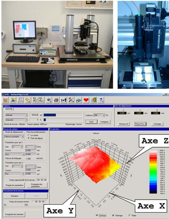
Dispositif de microtopographie STIL CHR au C2RMF, Paris Phot. N. Mélard. © C2RMF/N. Mélard
