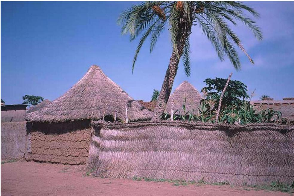
Rey Bouba. Matériaux traditionnels utilisés dans la construction d'un *saré* ou concession familiale : terre, chaume et panneaux de vannerie ou *sekko*
