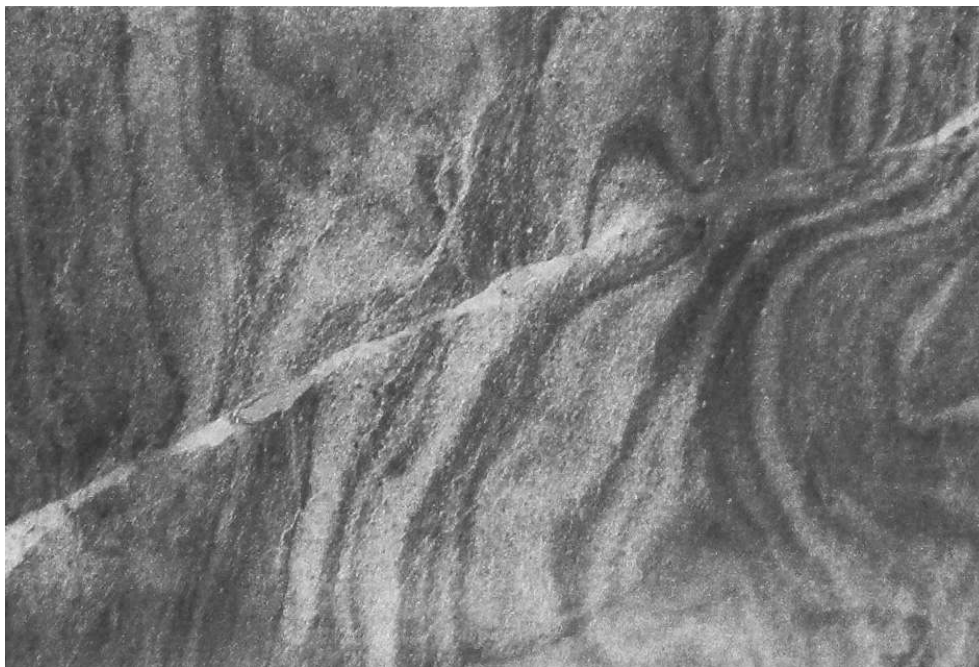
Photo VII : Sciage oblique à la stratification dans le grès rose d'Erquy, faisant apparaître des motifs en drapé.
