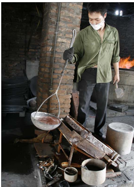
Illustration 12 – Fonte de l'aluminium à Dai Bai
