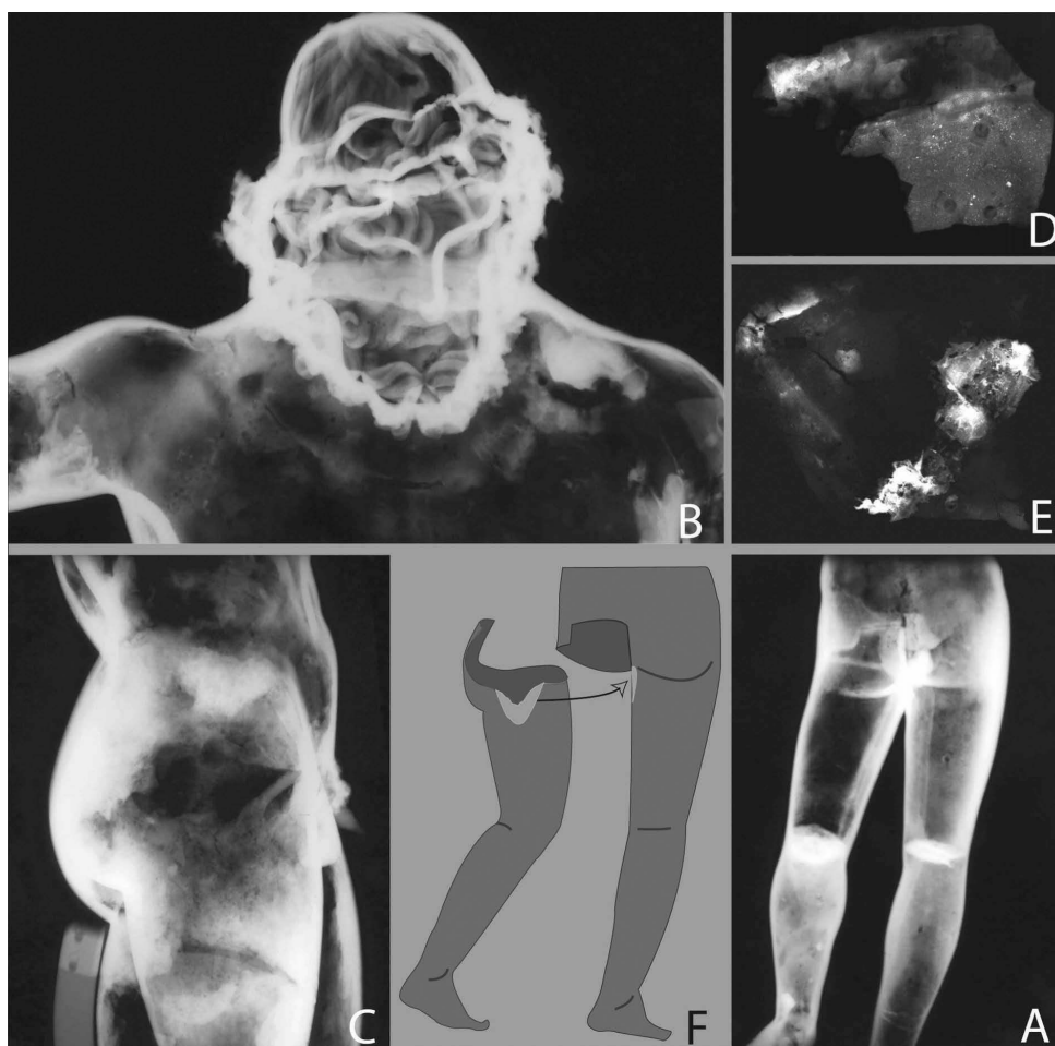
Figure 2 : Radiographies X des jambes d'Apollon (A), du buste (B) et des jambes (C) de Jupiter, et des fragments C2RMF69362 (D) et C2RMF69516 (E) © T. Borel C2RMF, schéma de la jonction entre la jambe gauche et le corps d'Apollon (F) © A. Azéma C2RMF.
