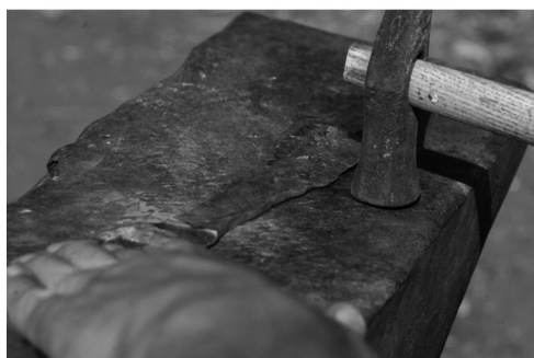
Martelage pour affiner les extrémités formant les ailettes
