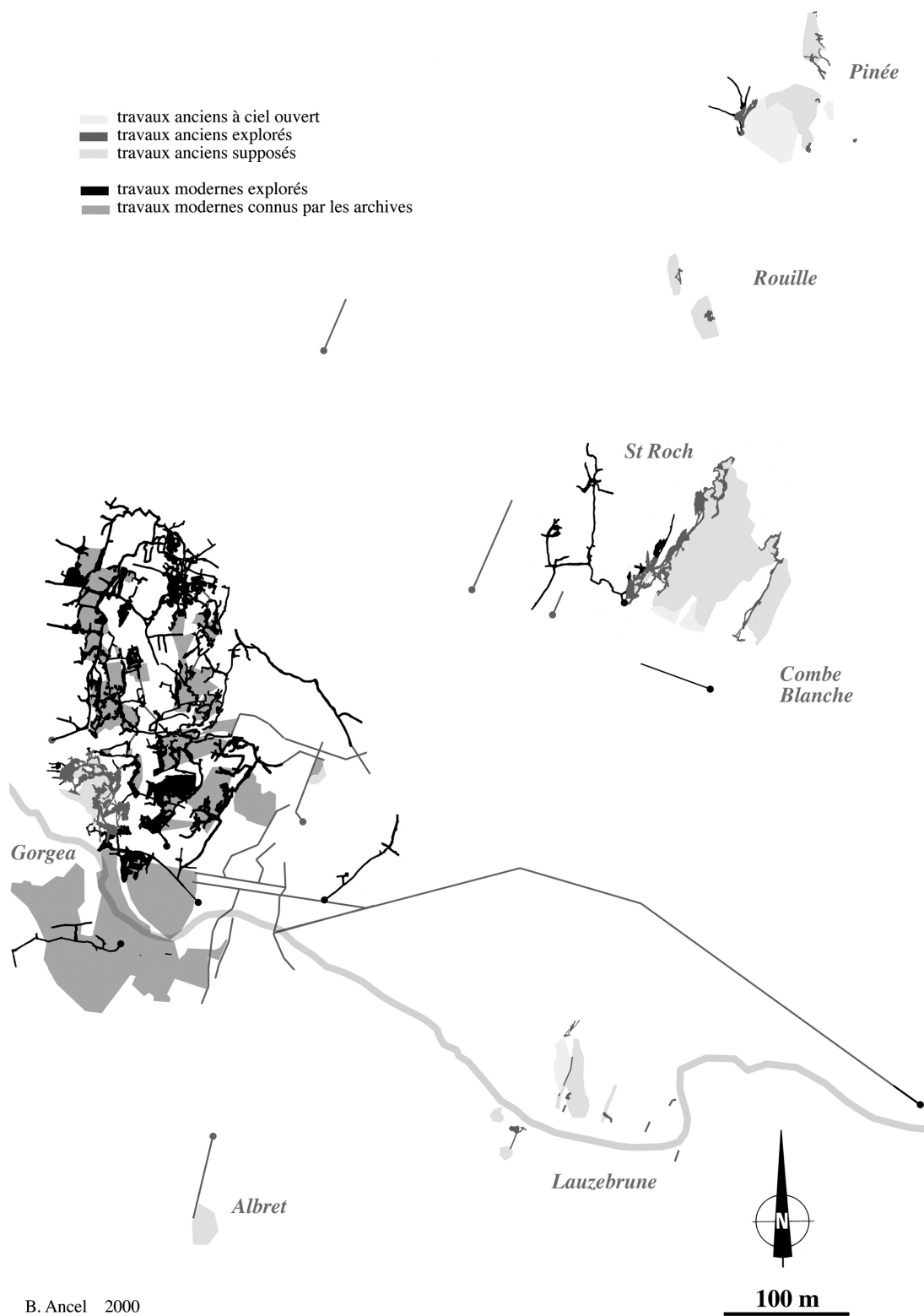
Figure 2 : (Voir planche couleur) Carte souterraine des travaux miniers du Fournel.
