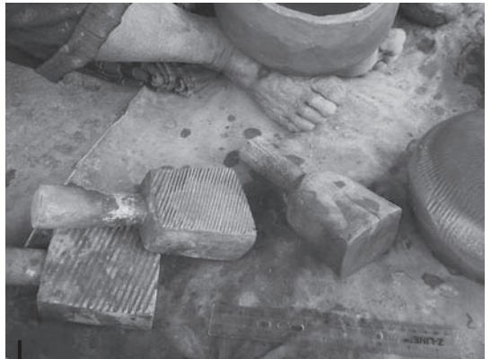
Figura 14 – Paletas para elaborar y decorar las ollas en Mangallpa
