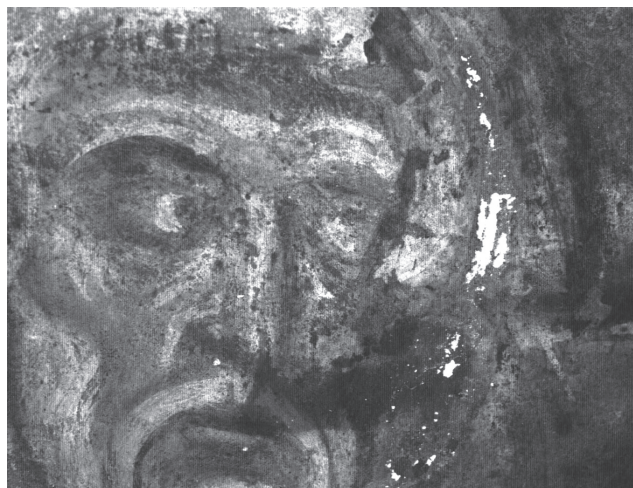
Figure 1 : (Voir planche couleur) Fluorescence jaune obtenue sous UV grâce à une caméra multispectrale sur l'auréole d'un des personnages des peintures murales de la voûte de la chapelle de l'ancien logis abbatial de Moissac (XII e siècle Tarn-et-Garonne). L'aspect bleuté de l'image correspond à la réflexion de la lumière ultraviolette par le support et non à une fluorescence.
