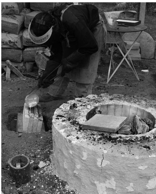
Figure 6 : Coulée du laiton (site des mines d'argent des rois francs de Melle, Deux Sèvres). Figure 6: Melting of the brass (site of the silver mines of the Frank kings in Melle, Deux-Sèvres).
