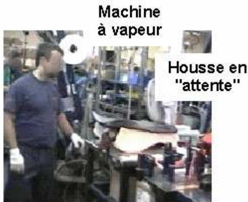
Figure 9. Photo présentant la situation où le travailleur dépose la housse sur le cadre-mousse en attendant de la placer sur la machine à vapeur
