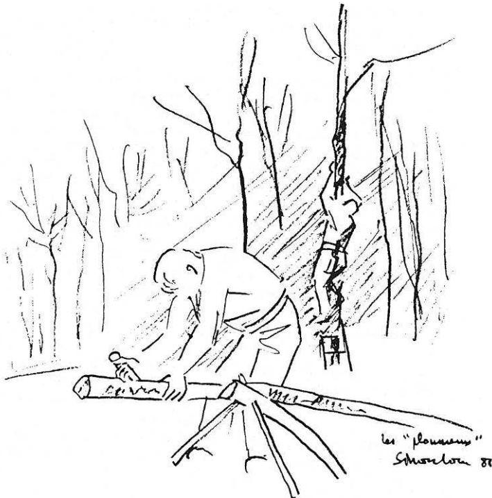
Figure 23 : Écorçage sur chevalet. Les ploumeux
