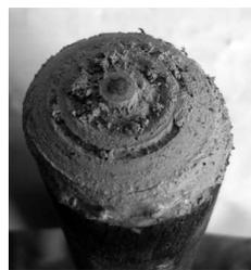
Figure 12. Extrémité d'une mèche de foret pleine expérimentale en bois.
