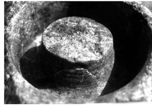
Figure 8. Exemple de carotte de forage expérimental se formant au centre du forage tubulaire.
