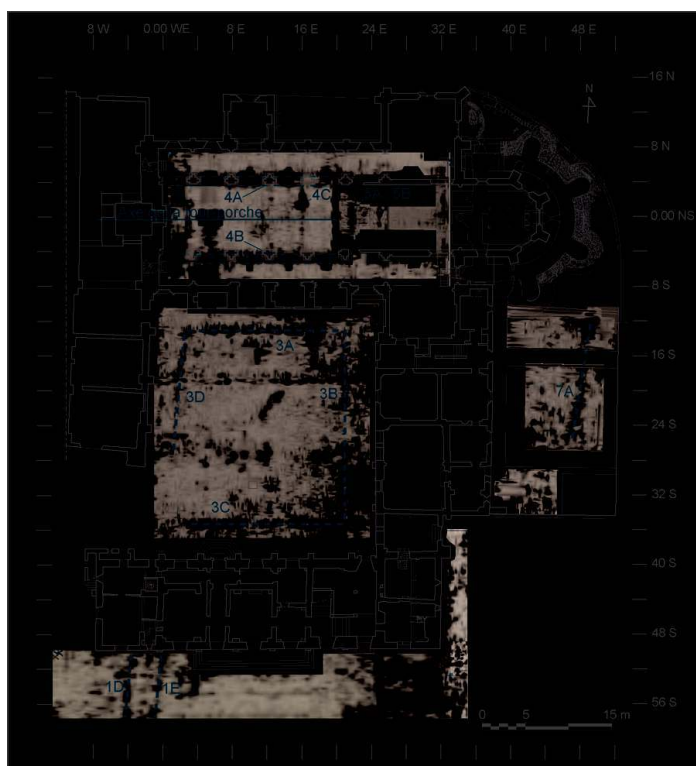
Fig. 1 – Images des réflexions radar à différentes profondeurs : - 1,80 m pour les secteurs 1 et 2 au sud du bâtiment sud (sauf zone restreinte au sud-est à - 2 m) ; - 1,50 m pour le secteur 3 (cloître) ; - 1,60 m pour le secteur 4 (nef et bas-côtés) ; - 1,40 m pour le secteur 5 (dernière travée de la nef et croisée du transept) ; - 1,60 m pour les secteurs 6 et 7 situés à l'est du presbytère (bâtiment est) ; plan D. Hénault, 2012, et images radar F. Donnadieu, P. Labazuy, A. Coperey et M. Beziaud, 2013.
