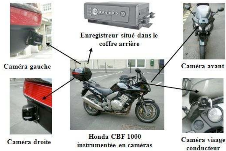
Figure 1 : Emplacement des quatre caméras embarquées et de l'enregistreur sur le véhicule équipé
