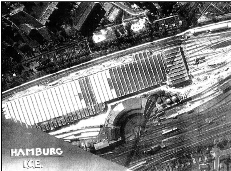
Figure 13. Vue aérienne à Hambourg (1990) du premier atelier et dépôt allemand pour rames à grande vitesse ICE. On notera qu'il intègre l'ancien dépôt vapeur devenu électrique et Diesel, pour locomotives, d'Altona-Nord (situé à Eidelstedt). Cl. Deutsche Bahn Ag., coll. Y. Machefert-Tassin.
