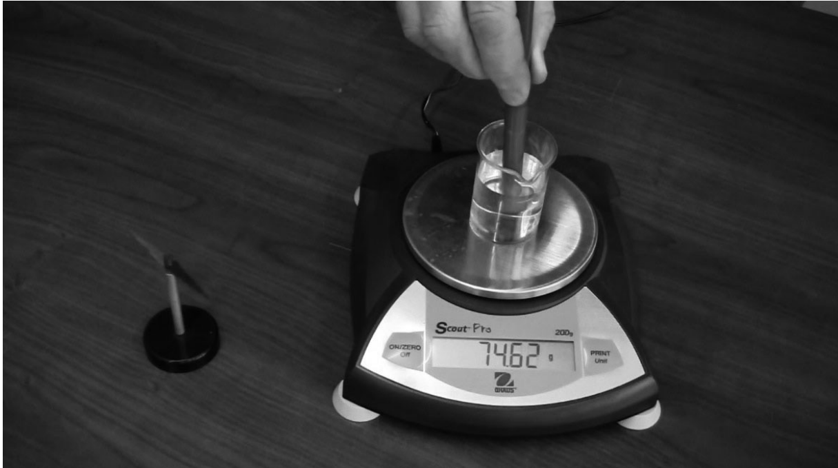
Figure 2. Pour ce clip vidéo, l'expérience est relative à la poussée d'Archimède. On demande aux spectateurs d'expliquer en quoi l'introduction d'un aimant dans un récipient rempli d'eau peut augmenter l'indication d'une balance sur lequel il est placé.
