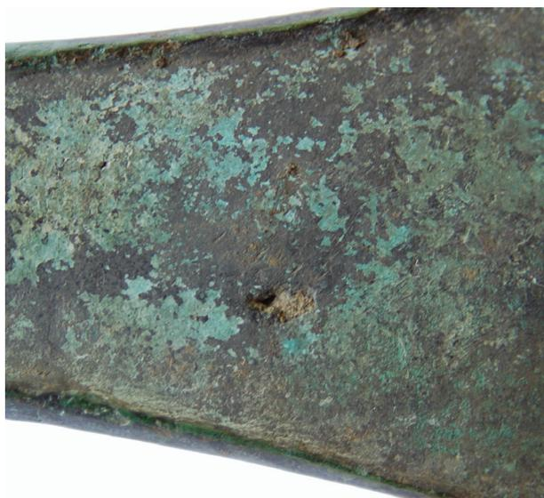
**Fig. 5.** Photo de détail montrant des lacunes de coulée (D. Stuart).
