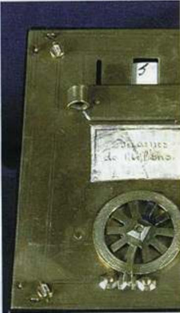
Remarquer les taches sur le laiton, l'oxydation due aux produits d'entretien, la restauration du papier et la nouvelle vis.
