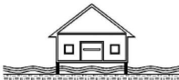
**élévation** du plancher de l'immeuble au dessus de la ligne d'eau
