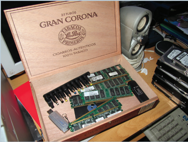
6. Boîte de Tilan contenant des mémoires centrales de rechange, destinées à être réutilisées dans le cadre d'une réparation ou d'une remise en état d'ordinateurs.
