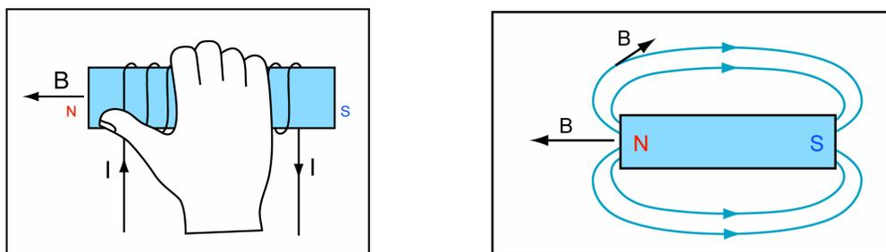
**Figure A2 : Un solénoïde** (à gauche) se comporte pratiquement comme un **barreau aimanté** (à droite). Le pôle nord est donné par la règle de la main droite : les doigts sont orientés dans le sens du courant électrique qui traverse la bobine, le pouce indique le sens du champ magnétique (pôle nord). (© Ilarion Pavel)
