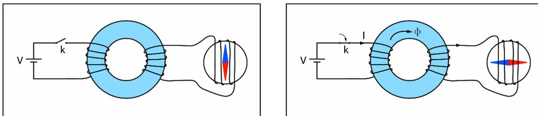
**Figure 6 : L'induction électromagnétique.** Lorsqu'on ferme l'interrupteur  $k$ , un courant électrique  $I$  apparaît dans la première bobine et engendre un champ magnétique variable dans le noyau toroïdal. La variation du champ magnétique donne alors naissance à un courant électrique dans la deuxième bobine, mis en évidence à l'aide d'un galvanomètre (© Ilarion Pavel).
