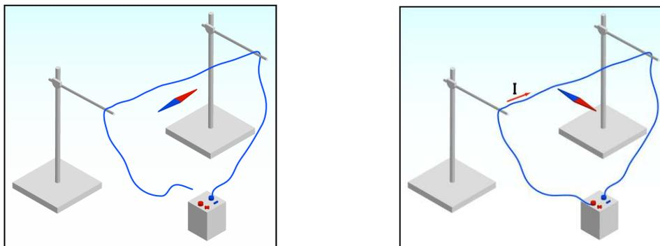
**Figure 2 : Expérience d'Ørsted.** Lorsqu'on ferme le circuit (à droite), le courant électrique qui passe par le conducteur engendre un champ magnétique, qui interagit avec l'aiguille de la boussole et la fait dévier. L'aiguille s'oriente perpendiculairement au conducteur (© Ilarion Pavel).
