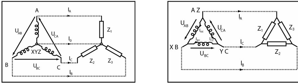
**Figure A12 : Connexion en étoile (gauche) et triangle (droite).** Le consommateur est représenté par les impédances  $Z_1$ ,  $Z_2$  et  $Z_3$ , les lignes de transmission sont en pointillés. (© Ilarion Pavel)
