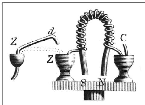
**Figure 3 :** *L'électroaimant de Sturgeon, formé de spires de cuivre enroulées sur un noyau de fer en forme de fer à cheval, pouvait soulever des masses de 4 kg. Les contacts électriques sont assurés par deux cuves contenant du mercure notées Z et C (la troisième cuve, à gauche, servait d'interrupteur par l'intermédiaire de la tige d). Le fil en*
