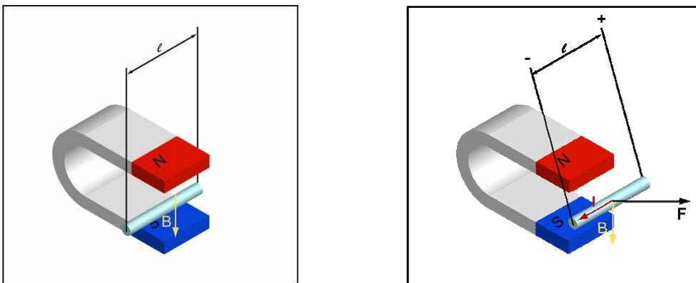
**Figure A3 : La force de Laplace.** Lorsqu'on fait passer un courant électrique à travers un conducteur suspendu par deux fils verticaux et situé dans un champ magnétique, le conducteur subit une force  $F$ , proportionnelle au courant  $I$ , au champ magnétique  $B$  et à la longueur du conducteur, et perpendiculaire au plan formé par le conducteur et le champ. Dans ce cas précis, l'angle entre le conducteur et le champ est de  $90^\circ$  (© Ilarion Pavel).
