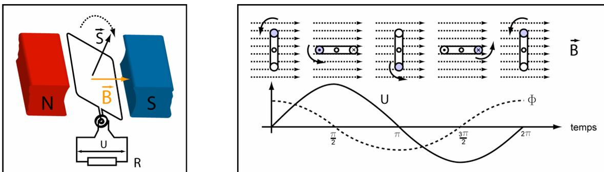
**Figure A7 : Principe du générateur électrique.** En variant la surface traversée par le champ magnétique  $B$ , la rotation du cadre mobile fait varier le flux  $\Phi$ , ce qui induit une tension électromotrice  $U$  dans le circuit. Si on branche un consommateur  $R$ , un courant alternatif apparaît dans le circuit (© Ilarion Pavel).
