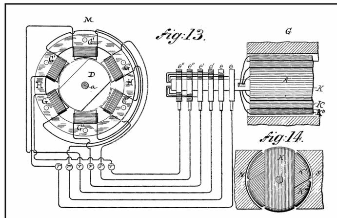
Le rotor est formé par un disque D ferromagnétique, comme dans le cas du système présenté initialement dans la figure 9, il n'y a donc pas besoin de système d'alimentation du rotor de type collecteur rotatif. La disposition des bobines, leur nombre (3 paires) et le faible entrefer (espace entre le noyau des bobines et le rotor) font obtenir un champ magnétique tournant bien plus fort, donc un moteur de meilleure puissance par rapport à celui de la figure 9.
