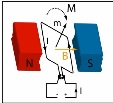
**Figure A5 : Le principe du moteur électrique.** Au moment où le moment magnétique du cadre  $m$  s'aligne avec le champ magnétique de l'aimant permanent  $B$ , la rotation du cadre est censée s'arrêter. Cependant, au même moment, la rotation du commutateur change le sens du courant dans la spire, donc celui du moment  $m$ . Pour l'aligner à nouveau dans la direction du champ magnétique, le cadre doit tourner et le processus se répète (© Ilarion Pavel).
