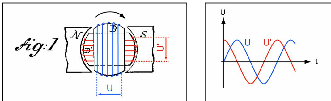
**Figure 12: Générateur de courant alternatif biphase** décrit dans le brevet, formé par deux bobines perpendiculaires B et B', tournant dans le champ magnétique d'un aimant permanent. À gauche, la position des bobines à l'instant  $t=0$ . Par souci de clarté, on a ajouté les enroulements des bobines. À droite, la courbe des signaux des tensions U et U' : elles sont déphasées de  $90^\circ$ .
