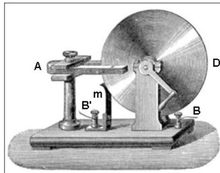
**Figure 7 :** *Le disque de Faraday tourne entre les pôles d'un aimant permanent A. Un fil du galvanomètre est connecté au contact B, lié à l'axe du disque D, l'autre fil au contact B', connecté à la jante par l'intermédiaire d'une lamelle élastique m (illustration Wikipédia).*
