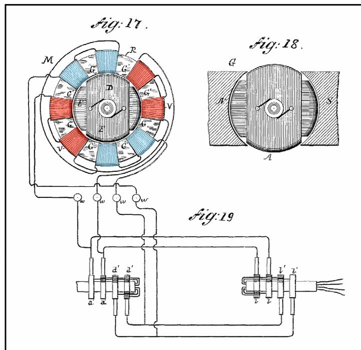
Le stator est bipolaire. Chacun des deux pôles (sur la figure 17, respectivement en rouge et en bleu) est formé de quatre bobines liées en série et diamétralement opposées deux par deux.
