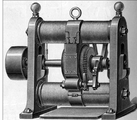
**Figure 11** : À gauche, la dynamo de Pacinotti. Le champ magnétique, produit par deux bobines verticales, traverse les bobines du rotor. Ce dernier, entraîné par une manivelle, tourne sur un axe vertical. À droite, la dynamo de Gramme. Le stator est le cadre en fer muni de quatre bobines, qui concentrent le champ magnétique dans le rotor (illustrations Wikipedia).
