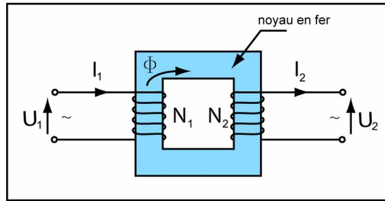
**Figure A19 : Le transformateur.** La tension électrique alternative  $U_1$  alimente la bobine primaire ( $N_1$  spires), produit un flux magnétique variable  $\Phi$  dans le noyau de fer, qui induit dans la bobine secondaire ( $N_2$  spires) une tension électrique  $U_2$  (© Ilarion Pavel).
