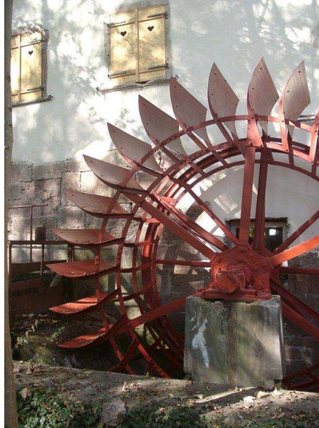
Figure 17 : Roue à aubes courbes de type Poncelet (moulin de Lutterbach, Alsace)
