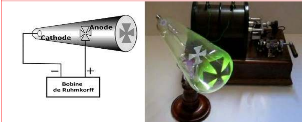
Figure 1 : Tube de Crookes (alimenté par une bobine de Ruhmkorff, visible à droite). Grâce au vide poussé au sein du tube, les électrons rencontrent peu de molécules sur leur trajet et conservent la grande vitesse (de l'ordre de 0,1c ) acquise grâce au champ électrique. Certains dépassent l'anode et provoquent une fluorescence du verre, accentuée lorsque le fond du tube est recouvert d'un matériau fluorescent. La projection de l'ombre de la croix de Malte amena Hittorf (1824-1914) à émettre l'hypothèse que quelque chose se déplaçait de manière rectiligne au sein du tube, ce qui sera baptisé « rayon cathodique ».
