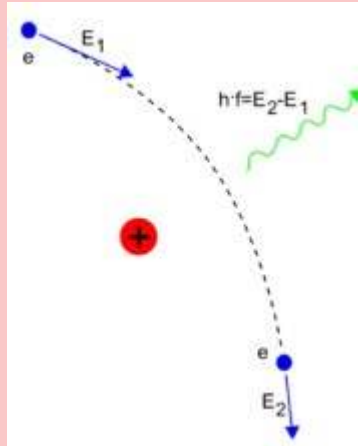
Figure 3 : Rayonnement de freinage. Les électrons passant à proximité des noyaux des atomes de la cible (à charge positive) sont déviés. Ils perdent de l'énergie et la différence d'énergie, pour un électron particulier, correspond à celle du photon X émis.
