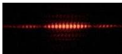
Figure 7 : Expérience des « fentes de Young ». L'onde provenant d'une source en haut, coupée sur la figure (image Wikipedia, Tatoute), arrive au niveau des deux fentes, et se forme une figure d'interférences, où l'intensité lumineuse reçue est représentée en bas (image Wikipedia, Jordgette).
