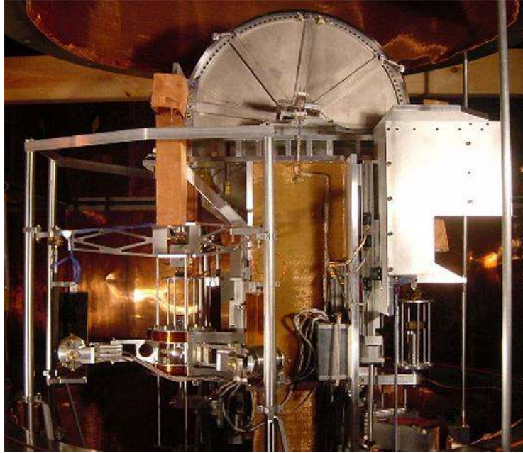
Figure 9 : La Balance du watt mesure le poids d'une bobine en la maintenant en lévitation à l'aide d'un courant électrique. Elle permettra de définir le kilogramme à partir d'unités électriques, ce qui rendra obsolète le kilogramme-étalon en platine iridié, qui se trouve à Sèvres (photo Wikipedia, Richard Steiner).
