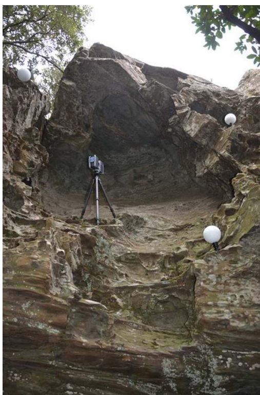
Fig. 1 – VUE DU DISPOSITIF DE NUMÉRISATION 3D PAR LASERGRAMMÉTRIE
