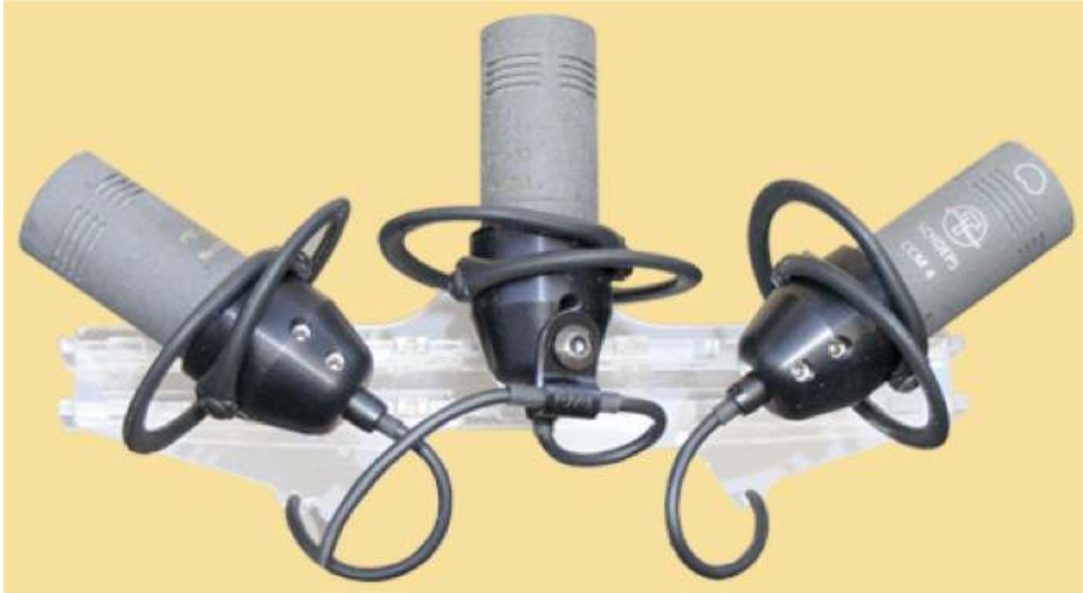
Fig 10 : dispositif de captation LCR http://www.cinela.fr/albert.php?language=fr
